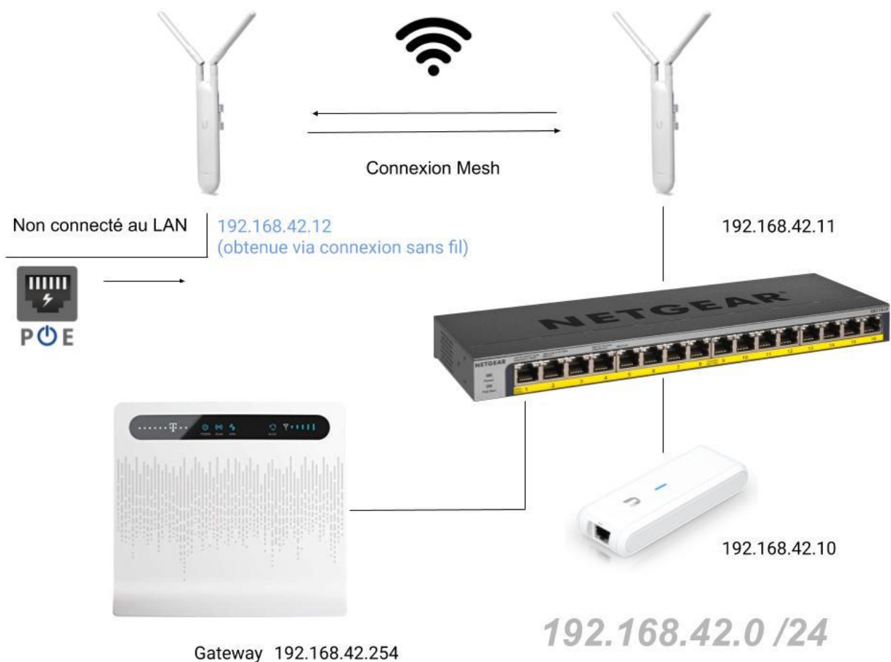
Figure 15 : Architecture de test pour Wi-Fi Unify
